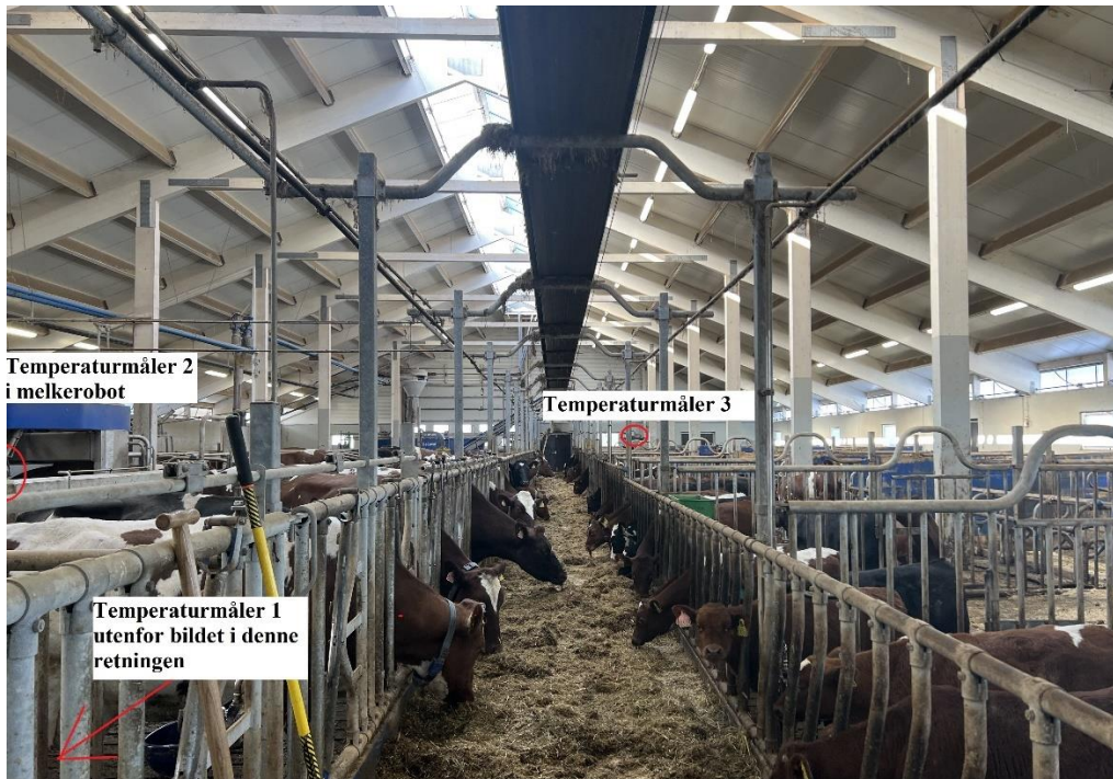
Figur 25: Bilde fra fjøs 3, med plassering av temperaturmålere. Foto: Ellen K. B. Johansen
