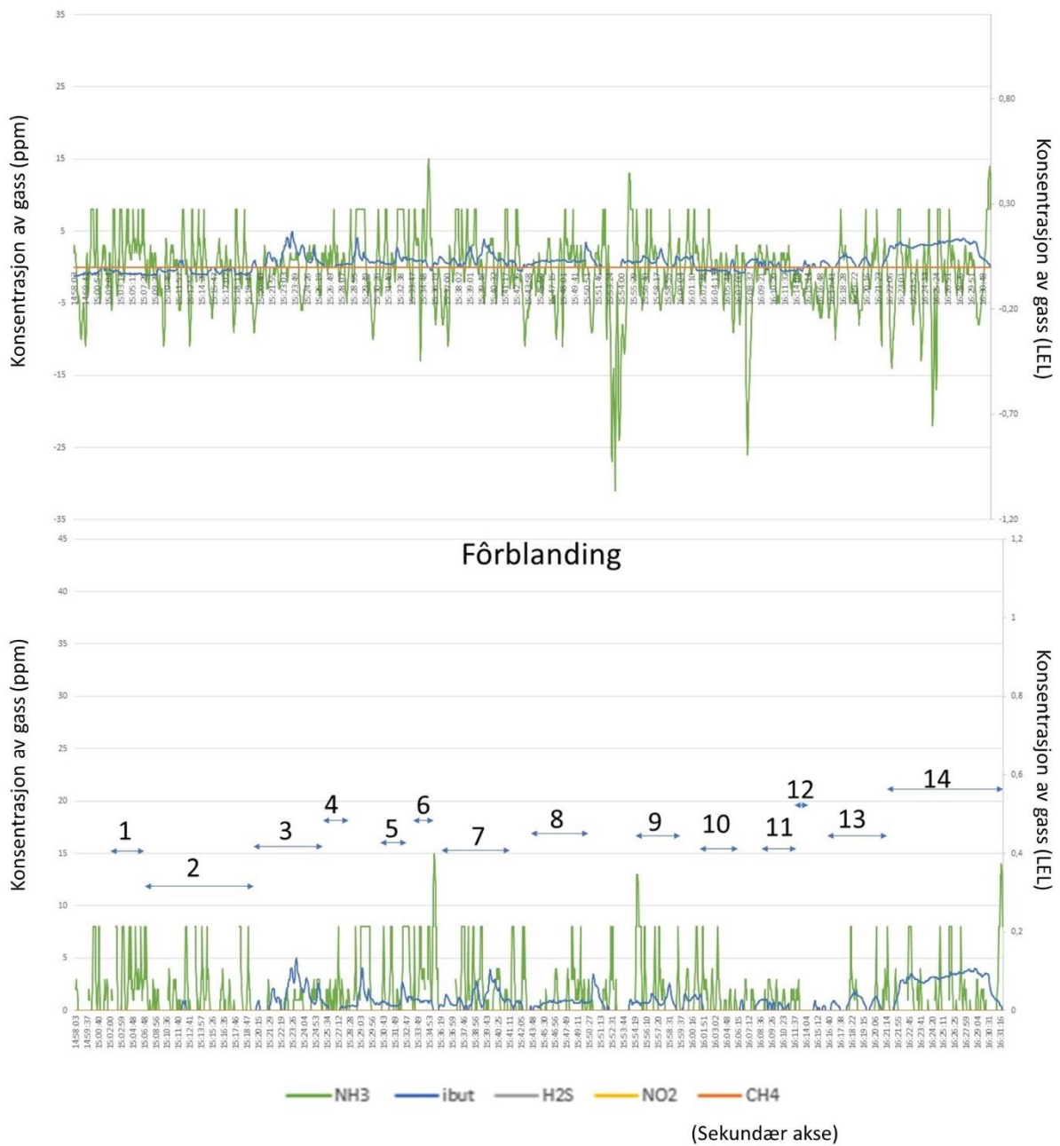
Figur 70: Gassmåling gård 3 fredag. Den øverste grafen viser den originale grafen, mens i den andre grafen er de negative verdiene fjernet.
