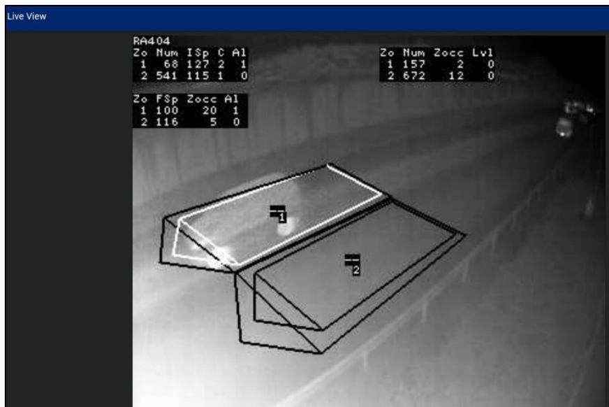
Figur 2.6: Detektor for måling av belegg nedstrøms på motorvegen. Hentet fra: (Fidgett & Undheim, 2023)
