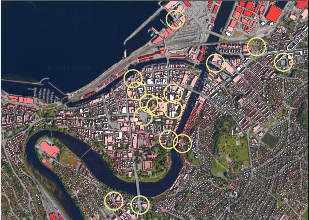
Figur 16: Morfometriske karakterer i Trondheim sentrum, her illustrert ved karakteren mdsAre - Område som nås av nærliggende gatesegmenter. Hvert bygningspolygon inneholder verdier for den enkelte bygningen, mens bufferne inneholder medianverdien av bygningene innenfor.
