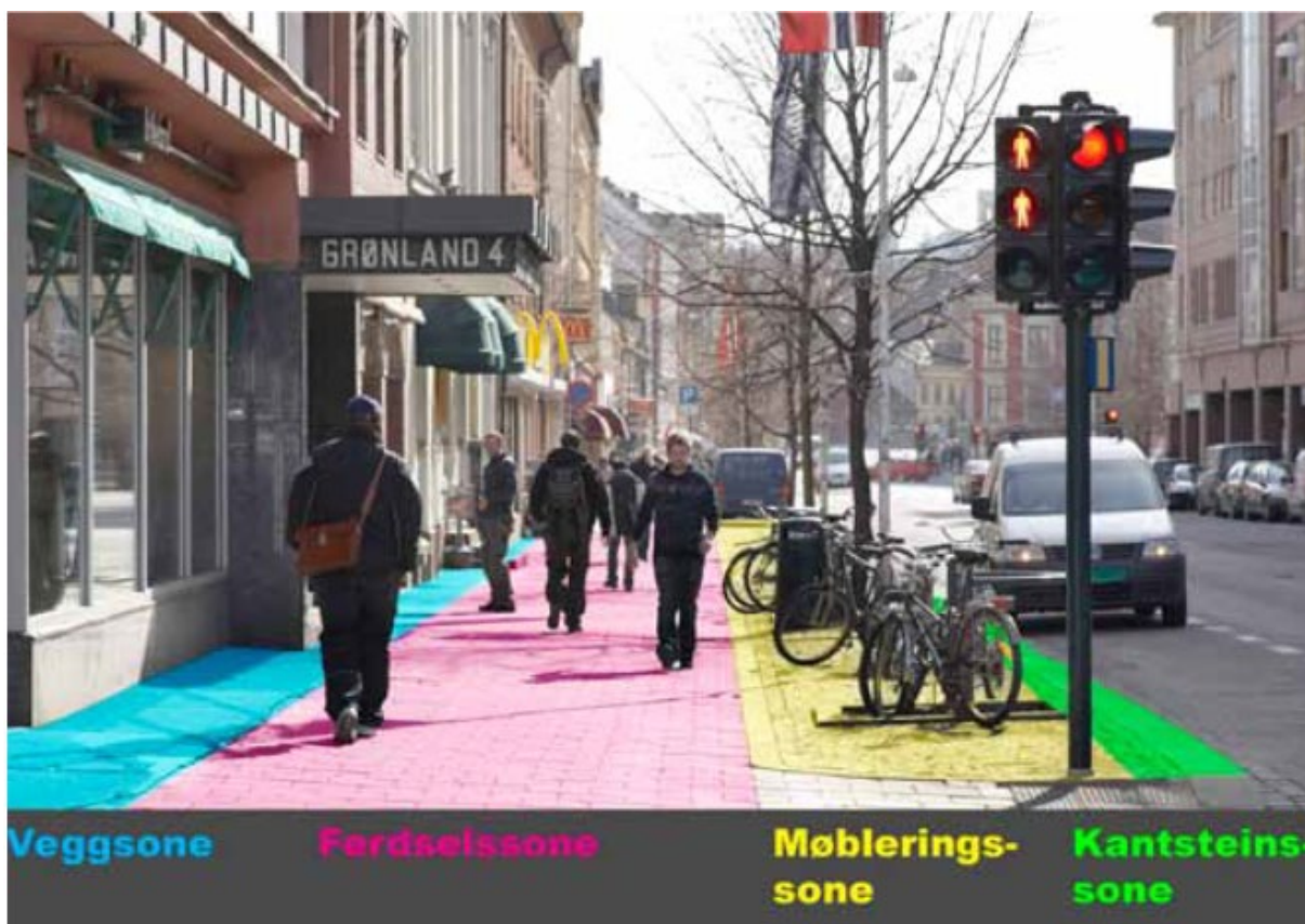
Figur 8: Eksempel på gatetverrsnitt med soneinndelingen. Legg merke til at møbleringssonen er sonen som tillater for trær. (Statens Vegvesen, 2014, s. 66).
