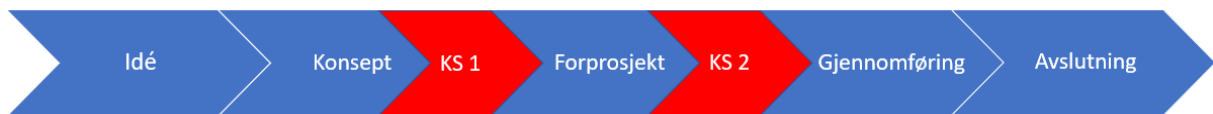
Figur 2.4 - Prosjektmodell for investeringer i forsvarssektoren. Kilde: Det Kongelige Finansdepartement, 2019, s.4; Det Kongelige Forsvarsdepartement, 2019, s.9; Haakonsen, 2022, s.9.
