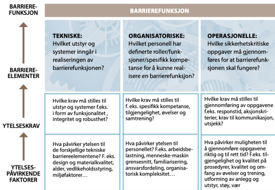
Figur 2: En oversikt som viser hvordan å ivareta en barriererefunksjon gjennom samspill mellom barriereelementer og deres ytelseskrav og -påvirkende faktorer (Ptil, 2017)
