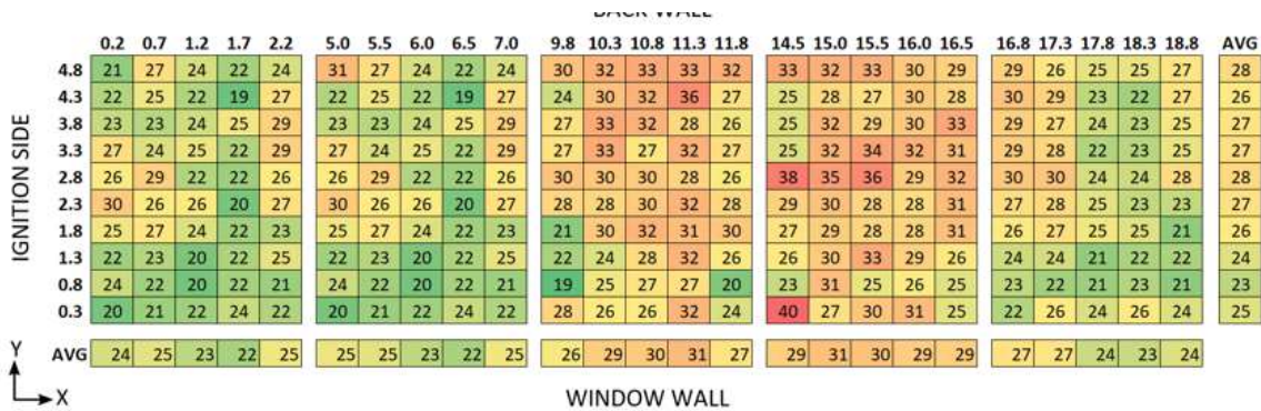
Figur 5 Forkullingsdybde på takelementet, eierskap Andreas Sæter Bøe
