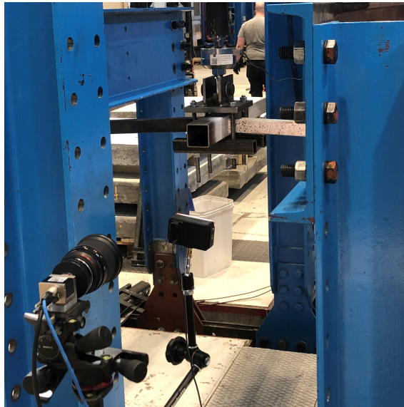
Figur 4.6: Kameraet plassering i forhold til prøvestykke
