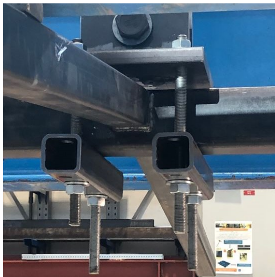
Figur 4.4: Opplageret til prøvestykket ved forskyvningspunktet
