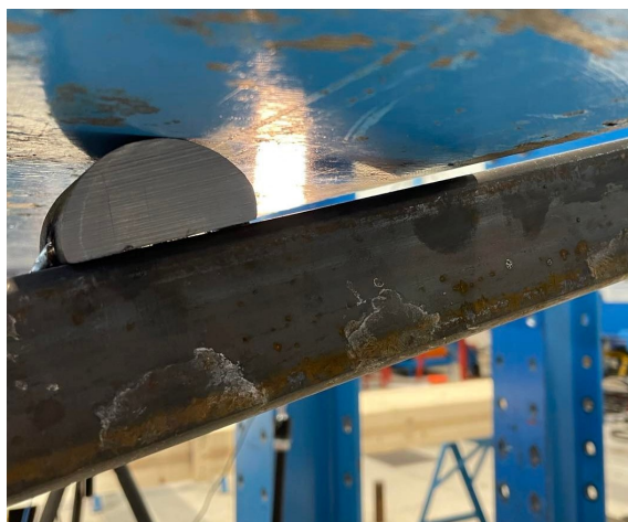
Figur 4.5: Opplageret til sekundær bjelkene ved I-bjelkene
