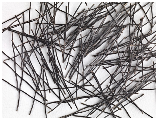
Figur 2.3.4: Minibar basaltfiber med diameter 0,65 mm og lengde 55 mm [17].
