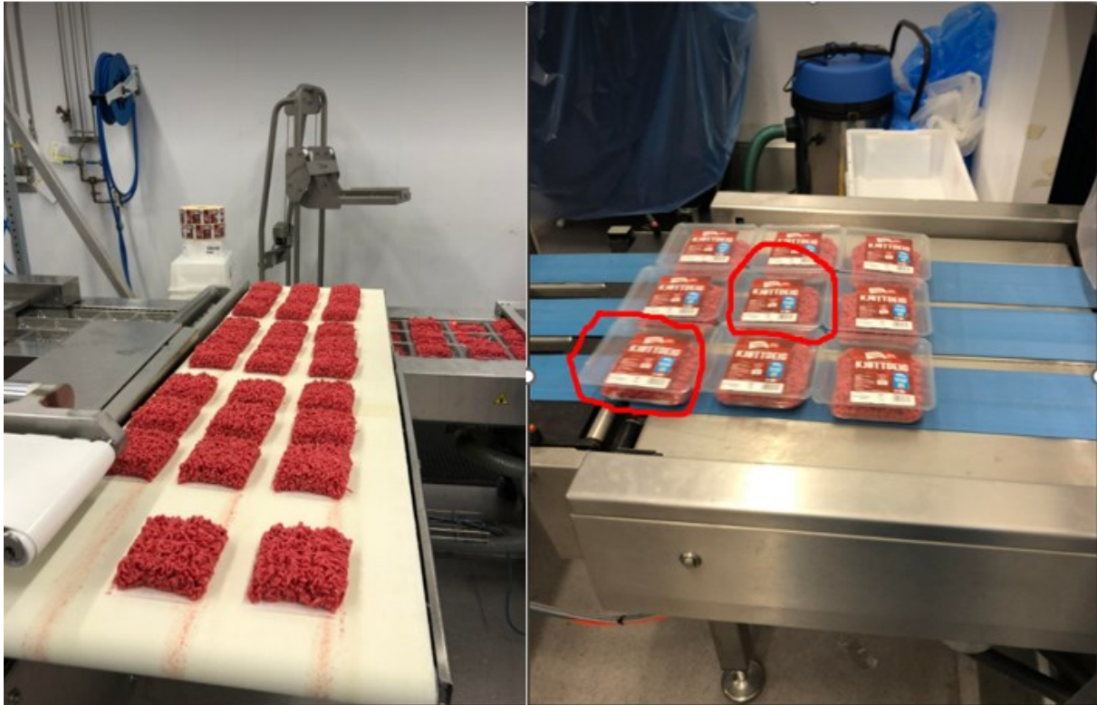
Bilde 9 viser hvordan pakkene ble lagt på båndet på vei inn i pakkemaskinen og hvilke pakker som ble plukket ut (Midtpakk og Ytterpakk). (Foto: Erlend S. Madsen)
