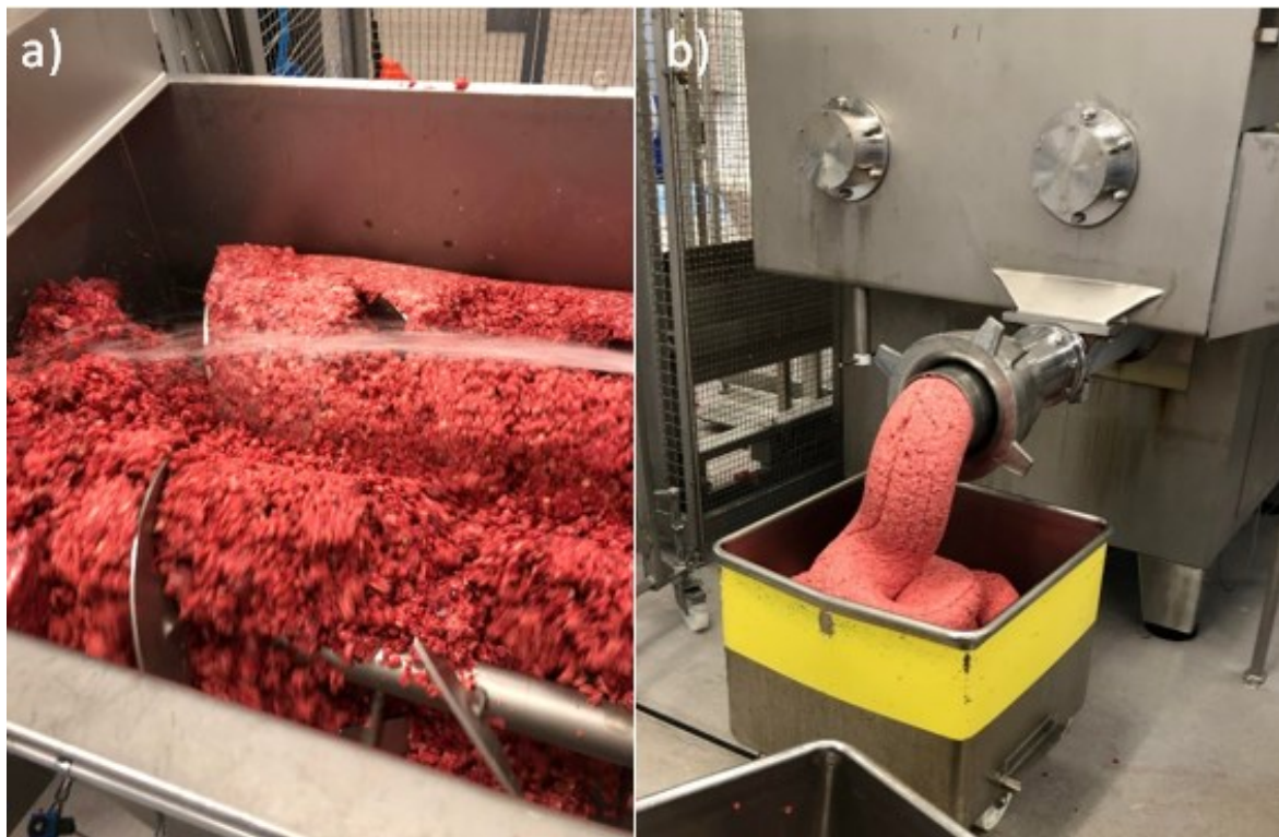
Bilde 4 viser kvernemaskinen fra toppen (a) hvor kjøttet blir puttet oppi sammen med den valgte nedkjølingsmetoden og hvor kjøttet kommer ferdig kvernet ut (b) som kjøttdeig (Foto: Erlend S. Madsen)
