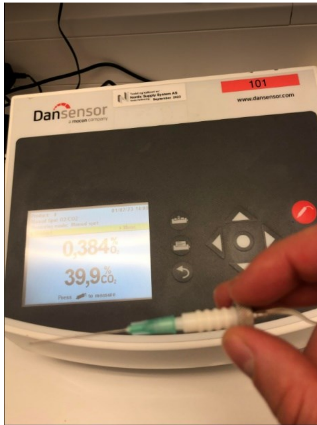
Bilde 10 Dansensor ChecMate3 viser restoksygen øverst på displayet og CO 2 nederst på displayet. (Foto: Erlend S. Madsen)
