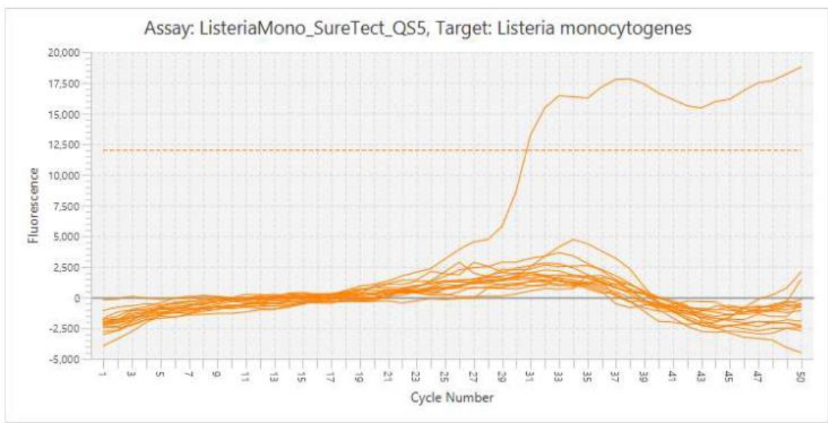
Figur 5.3: Øverst: Amplifiseringskurve som viser positivt resultat for den interne amplifiseringskontrollen (IAC), testen ble gjennomført korrekt. Nederst: Resultat av PCR L. monocytogenes dag 3 som viser negative prøver, inkludert non-template control (NTC).
