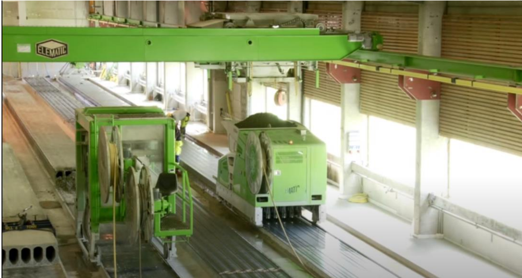
Figur 10 Produksjon av hulldekker (Voss Cementvarefabrikk)
