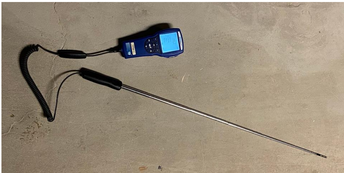
Fig. 9: Luftfuktmåler i Pirbadett. Fra befaring 4. mai
