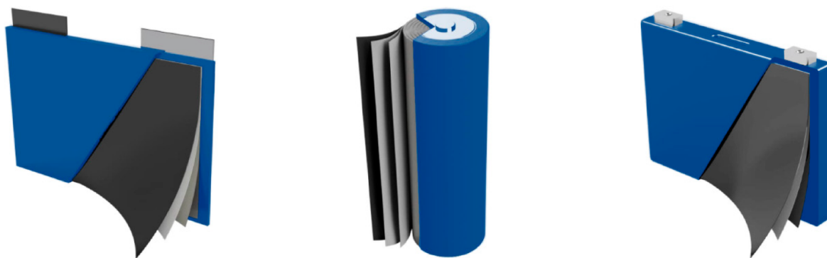
Figur 2.9: Fra venstre: posecelle, sylindrisk og prismatisk celle [39].
