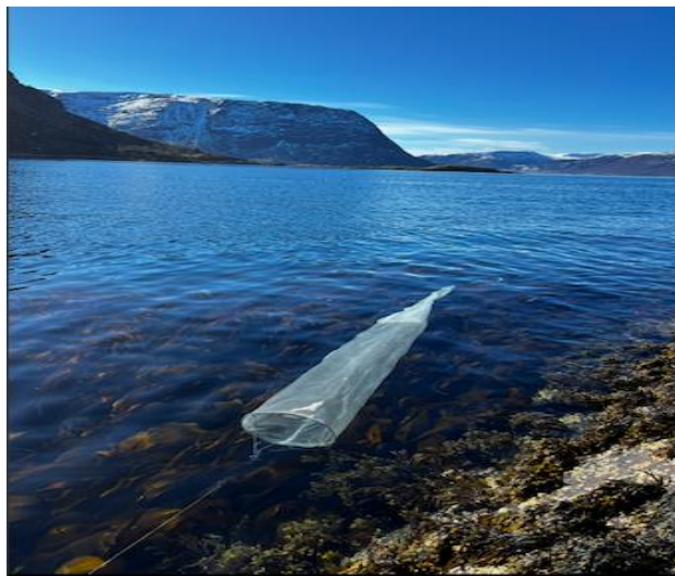
Figur 5. Planktonhåv benyttet til innsamling av plankton ved bruk av horisontal innsamlingsmetode. Spesifikasjoner; Lengde; 5 meter, Åpning; 50 cm i diameter.
