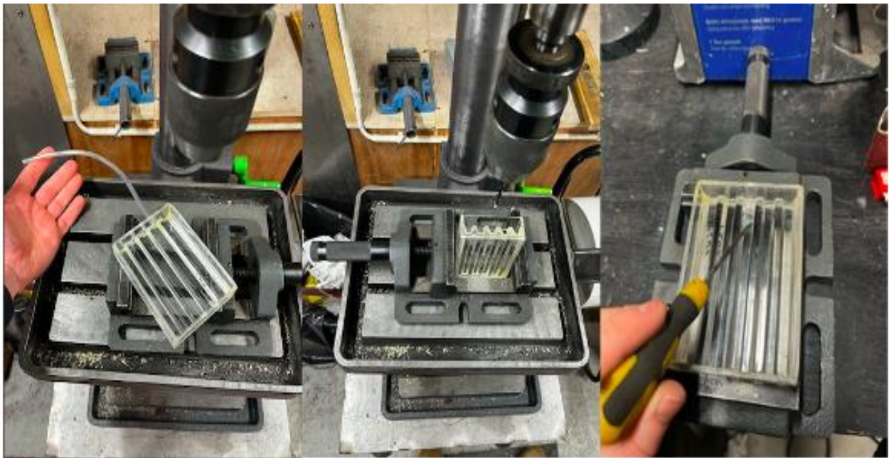
Figur 11. Illustrasjon av utviklingen av observasjonskammeret. Bildene viser tre ulike steg ved utformingen av observasjonskammeret. Boring av hull, pussing av kanaler og tilpassing til pumpe slanger.
