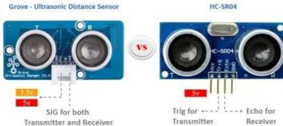
Figur 34 - Grove Ultrasonic sensor og HC-SR04
