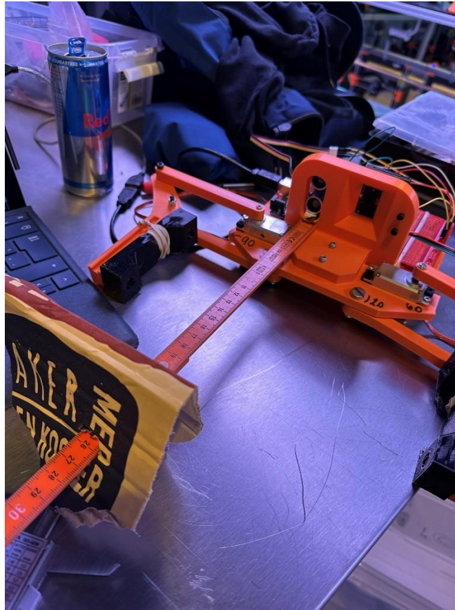
Figur 35 - Kalibrering av avstandsmåler
