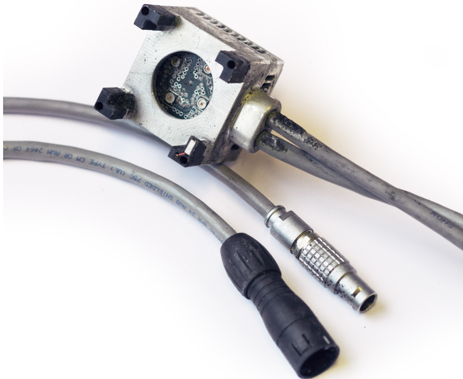
Figur 6.3: Bilde av LED-hodet med skader fra brannen. Fotokreditering: Anders Rønning Petersen v/Intitutt for Teknisk Kybernetikk.
