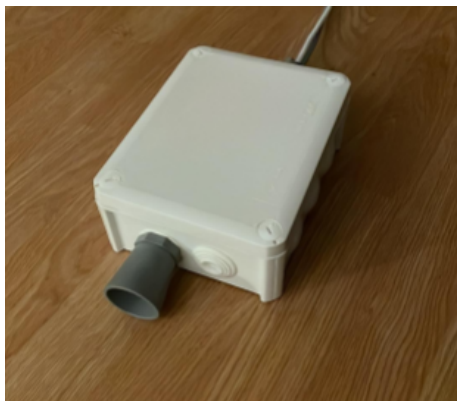
[32]: Lukket kapsling med snødydesensor foran. Foto: Jørgen Johannessen
