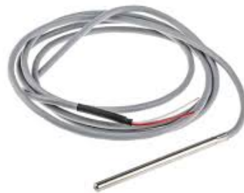
[6]: PT1000 Temperaturfølerelement. Metallbasert med høy nøyaktighet og robusthet. (RS, u.d.)
