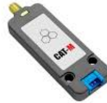
[5]: NB-IoT modul brukt for å kommunisere mellom blant annet mange sensorer. Bruker 4G og 5G nettet. (Elfa Distrelec, u.d.d)
