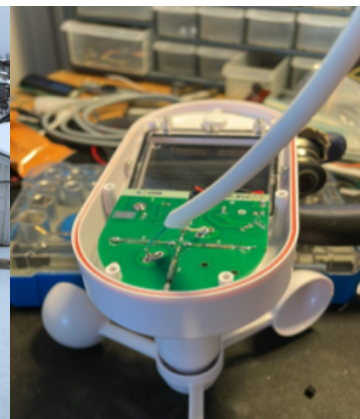
[9]: Vindsensoren åpnet og modifisert for å kunne direkte tilkobles til produktet. Foto: Jørgen Johannessen
