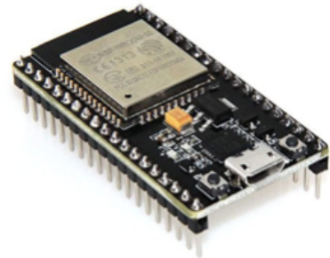
[4]: ESP32-modul, mikrokontrolleren som styrer den trådløse kommunikasjonen i prosjektet. (Surplustronics, u.d.)
