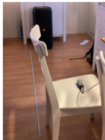
[21]: Første testing av ultralydsensoren MB7374-100. Foto: Jørgen Johannessen
