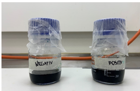
Figur 18: Volumendring i elektrolytt-reservoarene til Nafion 212. Her vil glassflasken merket med «negativ» være anolytt, og glassflasken merket med «positiv» være katolytt.
