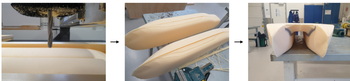
Figur 10.4: Produksjonen av modellen fra fres til sammenlimt skrogmodell.
