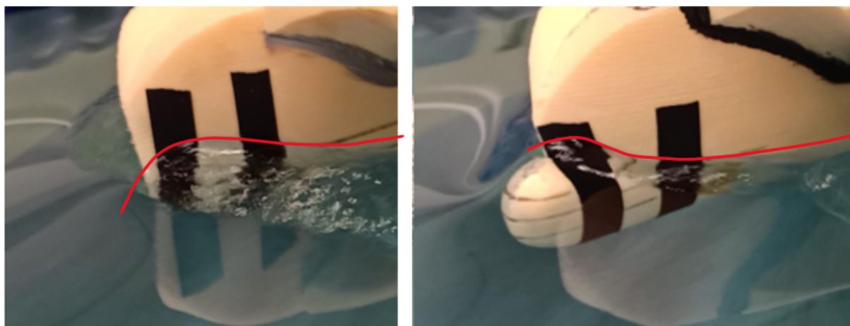
Figur 10.10: En visuell sammenlikning av modellene i 8 knops slep. En rød linje som indikerer baugbølgen er lagt over.
