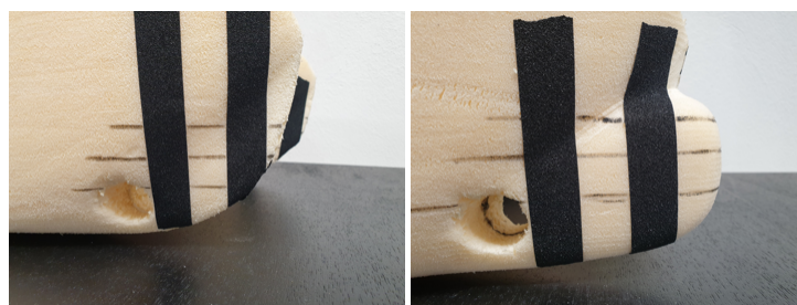
Figur 10.6: Striper av antisklitape på begge modellene ved baugen.
