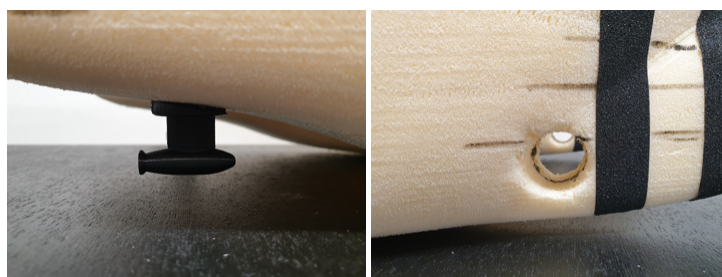
Figur 10.5: Pod-stammer og thruster-tunnel på modellene.
