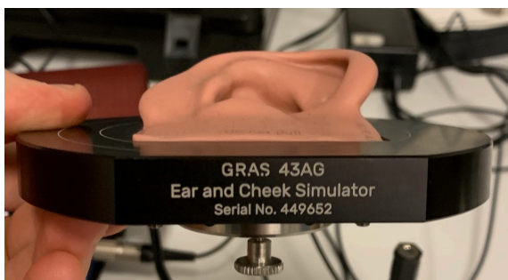
(a) ”Anthropometric pinna” allerede montert på ”øre og kinn-simulator”
