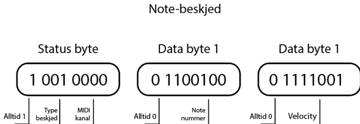
Figur 1 – Oppbygningen til en typisk MIDI-beskjed
