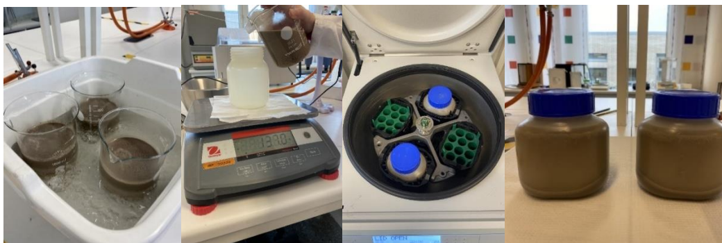
Figur 5: Bilde 12-15 viser nedkjøling og sentrifugering av restråstoffet
