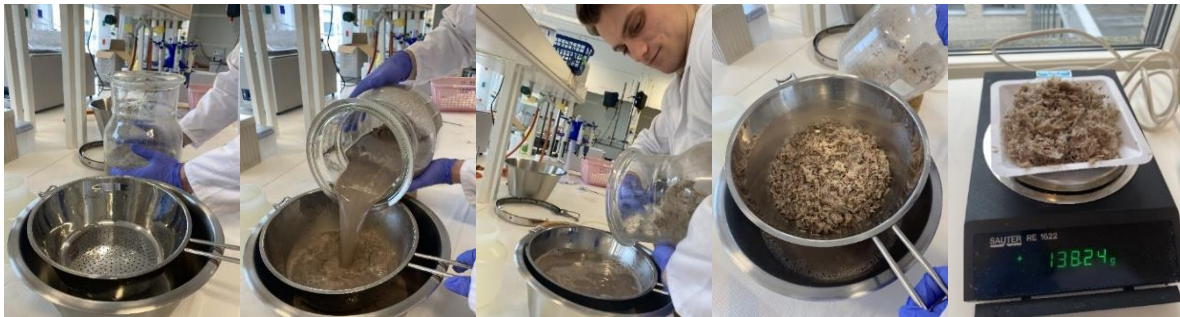
Figur 4: Bilde 7-11 viser løsningen som filtreres og beinrester som blir målt
