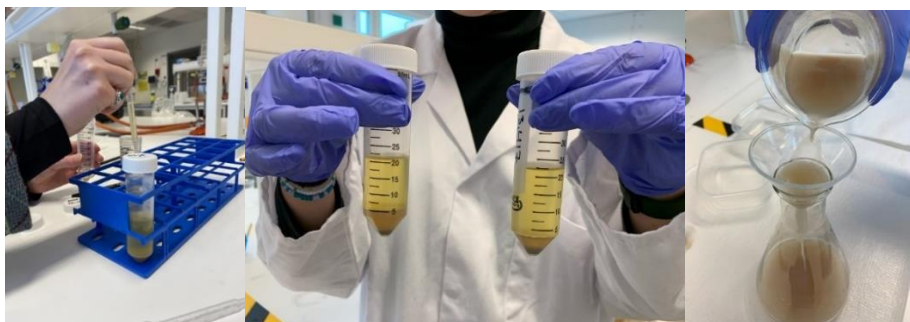
Figur 6: Bilde 16-18 viser separering av fraksjoner, lipidfraksjon og filtering av hydrolysat gjennom glassull
