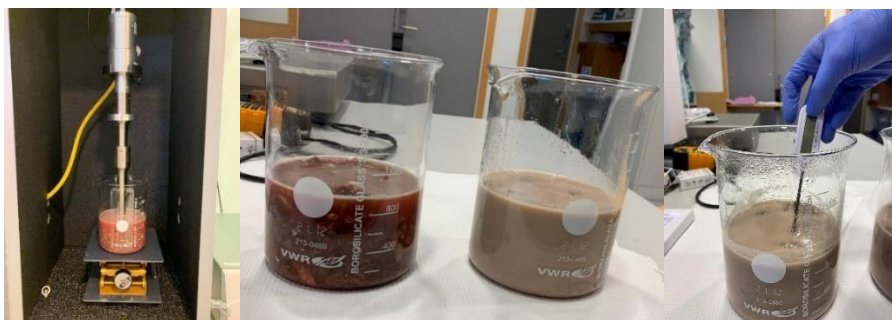
Figur 7: Bilde 19-21 viser maskinen som ble benyttet til ultralyd, restråstoffløsning før og etter ultralyd og temperaturmåling etter ultralydbehandling
