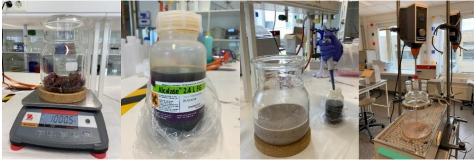
Figur 3: Bilde 3-6 viser oppveid restråstoff som ble tilsatt enzym før hydrolyseprosessen foregikk med mekanisk omrøring i glassbeholder
