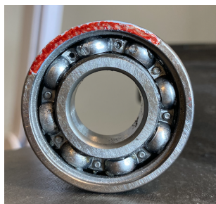
Figur 5: Lagerskade yttering og kuleholder
