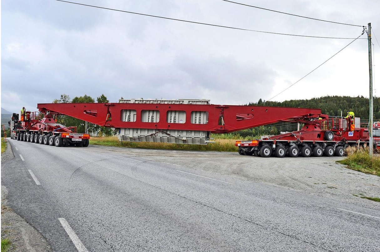
Figur 22 Viser bilde av spesialtransport som er 66 meter langt og 3,3 meter bredt som transporterer 332 tonn Statnett transformator på vegnettet (NYE TROMS, 2021)
