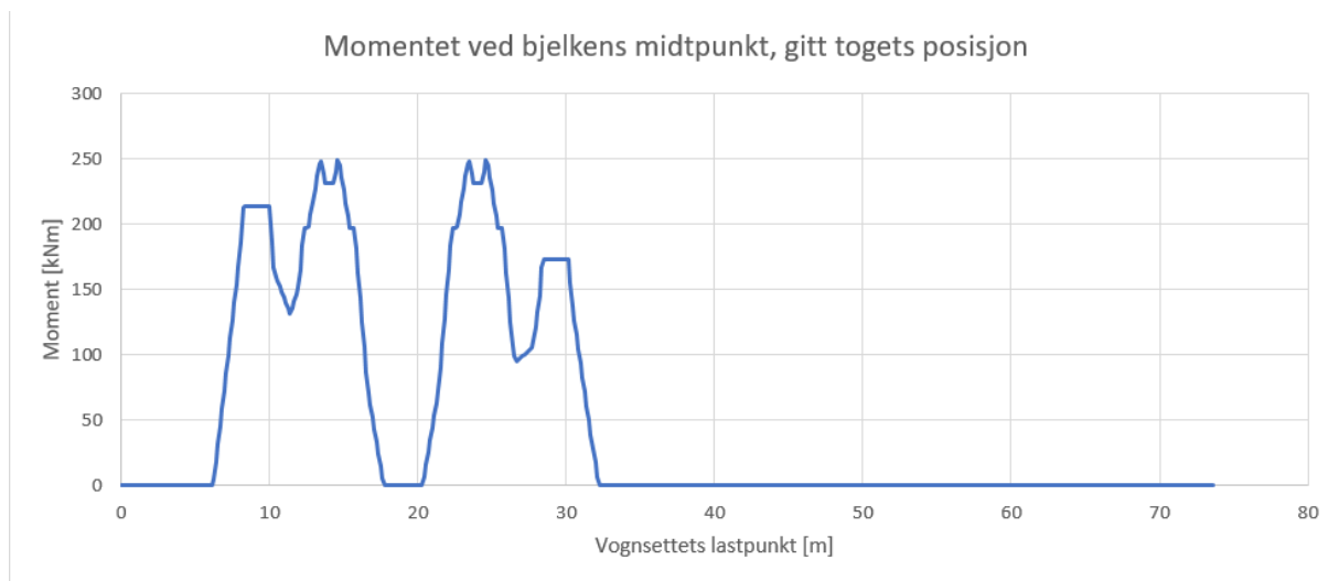
Figur 16 Viser størst bøyemoment 249,1 kN ved den akkumulert akselavstand på 23,72 m fra startpunktet (Bane NOR-Moving load, 2021)
