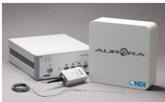
Figur 3: Aurora trackingsystem. Kontrollboks (bak), elektromagnetisk feltgenerator (til høyre) og elektromagnetisk sensor (foran, ikke samme type som brukt i denne studien) ( www.ndigital.com )
