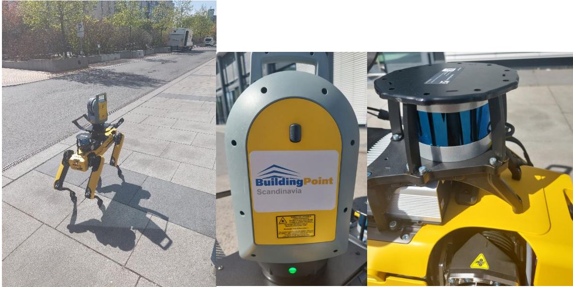
Figur 24: "Spot" i aksjon, med trimble skanner og LIDaR navigasjon
