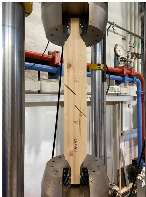
Figur 4.5: Bilde av et prøvestykke som er innfestet i prøvemaskinen M5 Instron 1325. Bildet er tatt før den sykliske belastningen.
