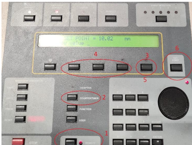
Figur 5: Framgangsmåte for å tilbakestille konsollen
