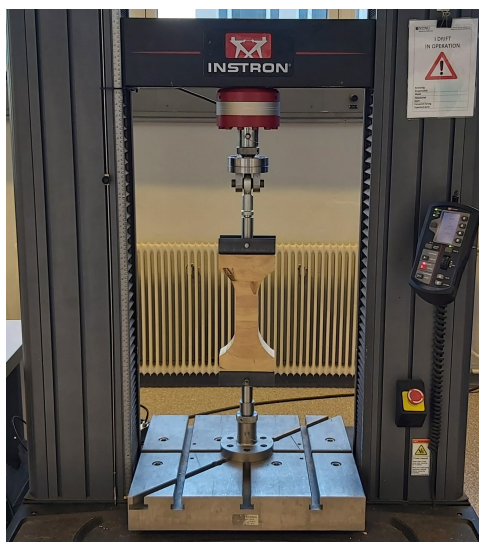
Figur 6.3: Illustrasjon av oppsettet til prøvestykkene i Instron 5982. Bildet er tatt før belastning.
