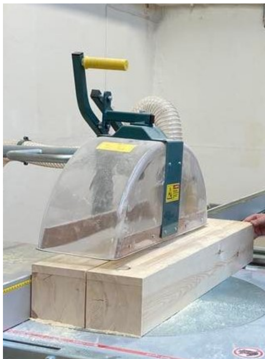
Figur 4.4: Langsgående saging av deler til prøvestykkene, ved bruk av sirkelsag.
