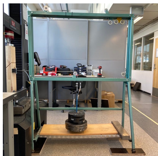
Figur 7.14: Stativ med trinsesystem festet til prøvestykke.
