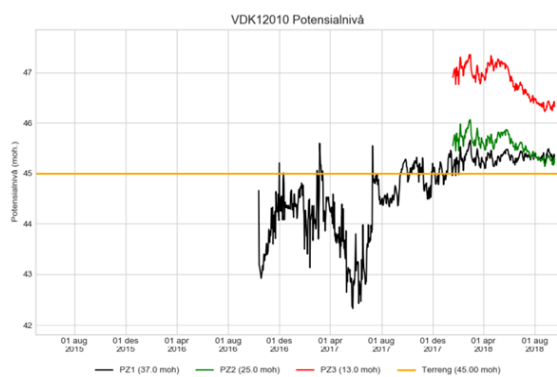
(a) Potensialnivåkurver for VDK12010 for ulike måledyp, (b) Avlest min, maks og snittverdi fra potensialkurven sammenlignet med det hydrostatiske trykket
