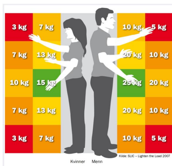
Figur 23 Vurderingsmodell for anbefalte løftegrenser i stående stilling, relatert til avstanden til kroppen
