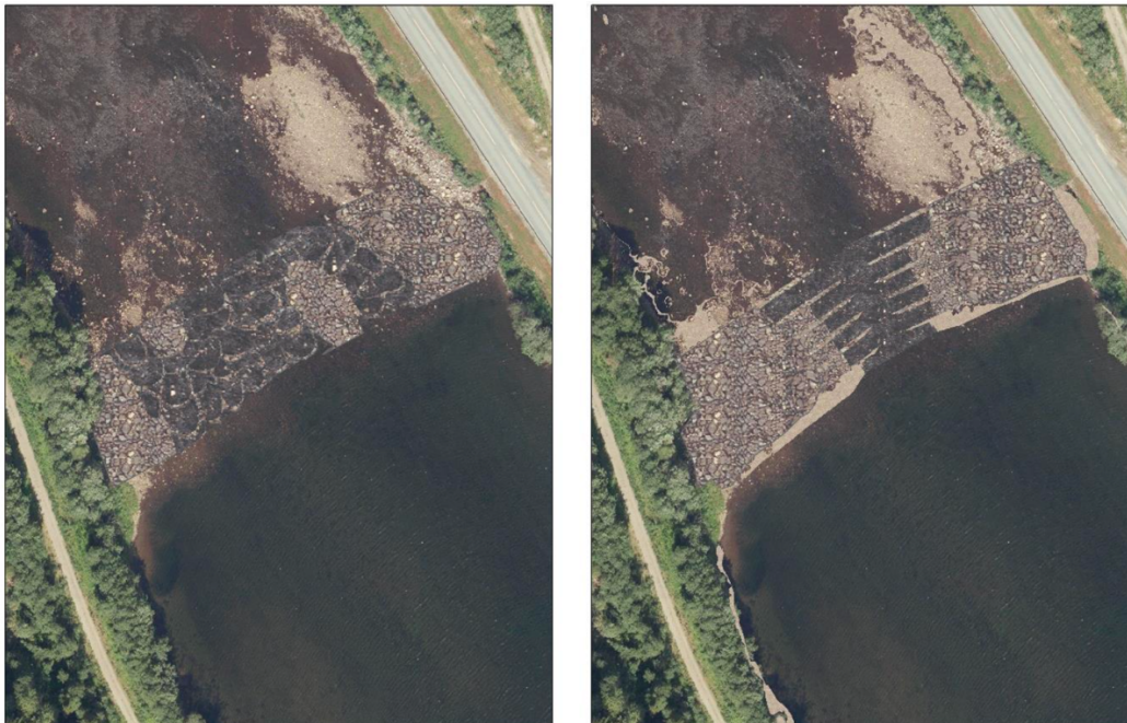
Figur 23 Terskel 22 som celleterskel (venstre) og trinnterskel. Frå (Brekke 2020)
