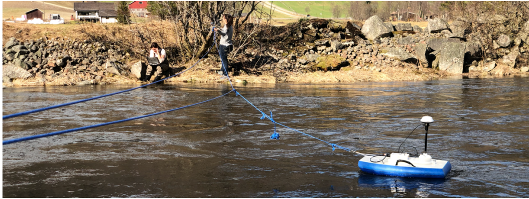
Figur 10 Oppmåling av kontrolldata i Storåne.
