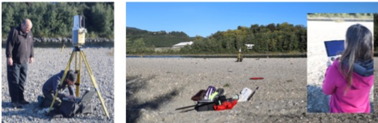
Figur 6 Oppmåling av kontrolldata for LiDAR på grusbanke.
