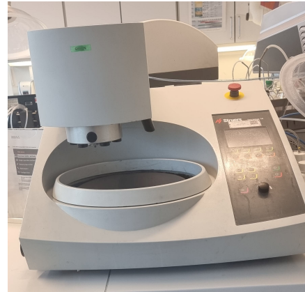
(d) Image of the polishing machine Tegramin-30 polisher.
