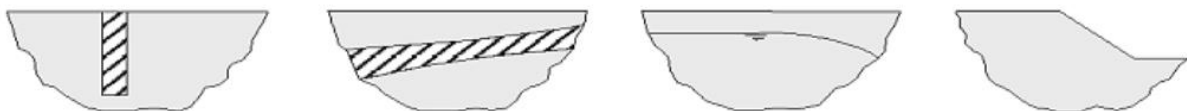
Figur 2.24 Situasjoner hvor K0-prosedyre ikke er anbefalt i PLAXIS (Brinkgreve et al. , 2021c).
