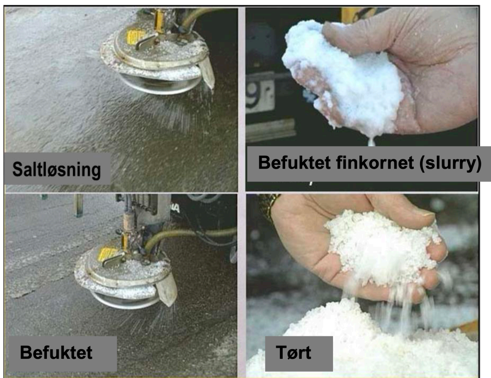
Figur 4: Spredemetoder for strøing med salt (SVV Nr.673 [10, s. 277]).
