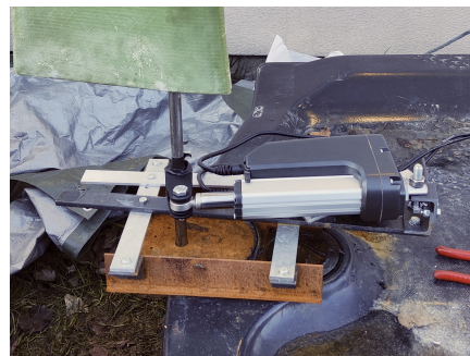
(d) Actuator mounted on boat with rudder
