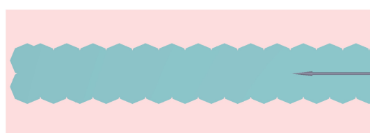
Figur 9.2 – KS-ribb med peler av 8-kantede polygoner.
