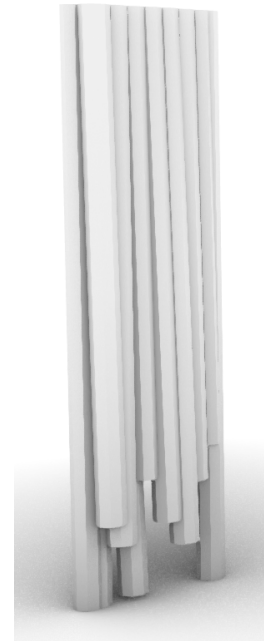
Figur 6.5 – En ribb sett skrått på, inkludert samtlige installasjonsavvik.
