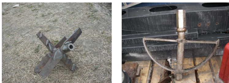
Figur 3.4 – Vanlige visper for installasjon av KS-peler [Eggen et al., 2012].
