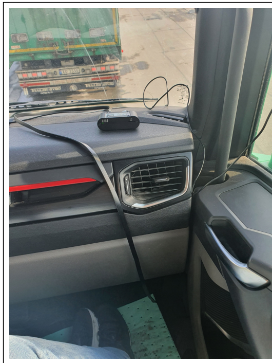
Figur 3.5: Oppsett av CANedge1 i førerhytte. (Foto: Aamodt)
