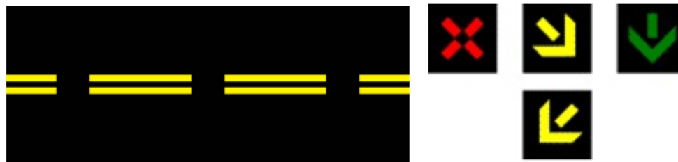
Figur 3.8: Dobbel varsellinje og signal 1090 for reversible kjørefelt i henhold til N302 og N303.
