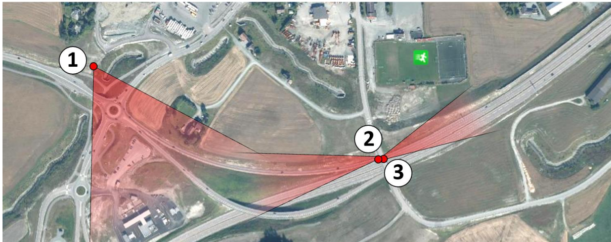
Figur 6.2 Plassering av kamera og synsfelt ved Klett-rundkjøringen
