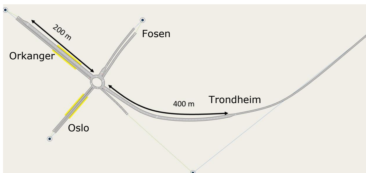
Figur 7.12 Helbilde av den nye utformingen av rundkjøringen på Klett modellert i Aimsun Next 22
