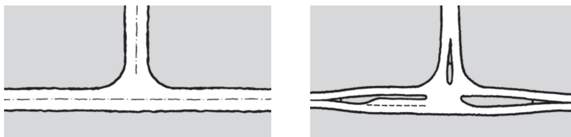
Figur 2.1 Ukanalisert og fullkanalisert T-kryss (Statens vegvesen, 2014d)
