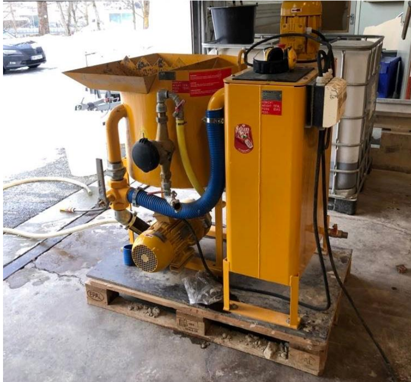
Figur 3.2: Kolloidalmikser benyttet til å blande injeksjonsmaterialer før testing. Merke: Häny HCM.
