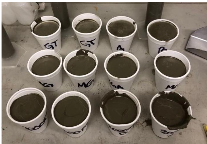
Figur 3.3: Kopptester av sementblandinger, med og uten størkningsakseleratorer.
