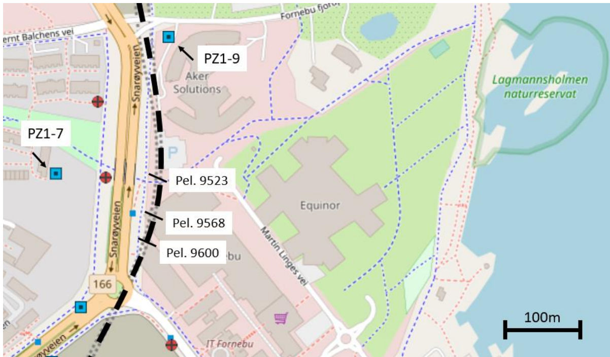
Figur 3.9: Plassering av poretrykksmålere og pelnummer for undersøkte injeksjonsskjermer. Den svarte stiplede linjen markerer traséen.
