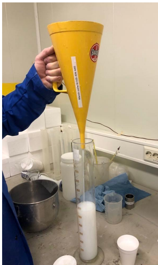
Figur 3.4: Marsh trakt-test utført på kolloidal silika.
