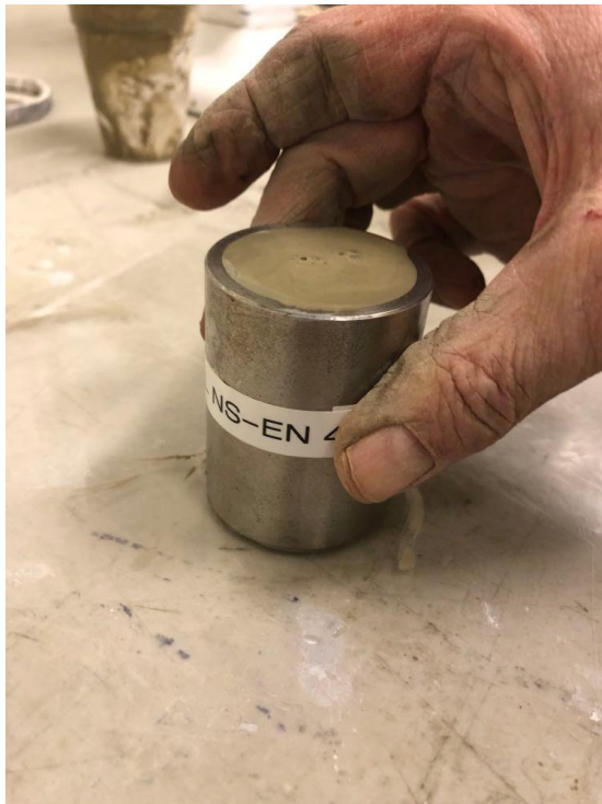
Figur 3.5: Utbredelsestest utført på en sementblanding.
