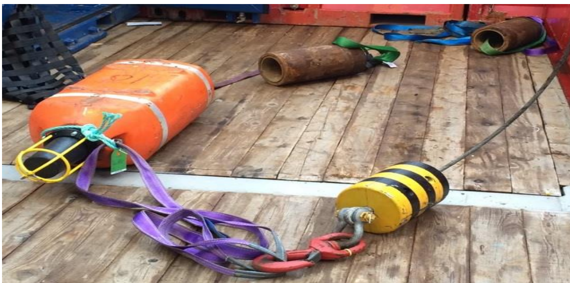
Figur 80: cNode transponder med TD30V30H, flytekrage, utløser og lodd.
