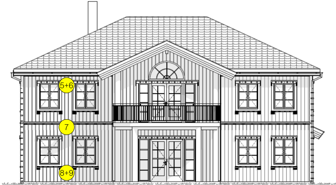
Figur 3.13: Fasade mot sør-vest i Norgeshus med markeringer av fuktsensorenes plassering. Utarbeidet etter instrumentering av Gullbrekken, Kvande og Time, 2021 og arbeidstegninger fra Norgeshus.
