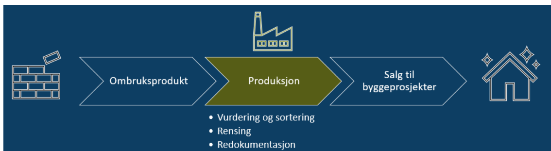
Figur 2.8: Illustrasjon av den industrialiserte produksjonsprosessen til Gamle Murstein (Fufa mfl., 2021).
