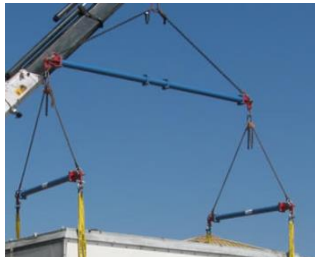
Bilde 2: Konstruksjon som kan reguleres i lengde- og bredderetning
