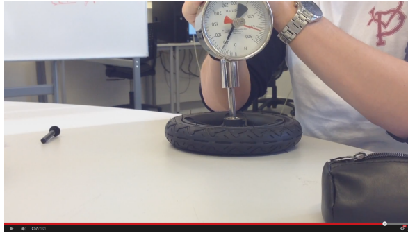
Figur 3.4: Måling av nødvendig kraft for montering av lager
