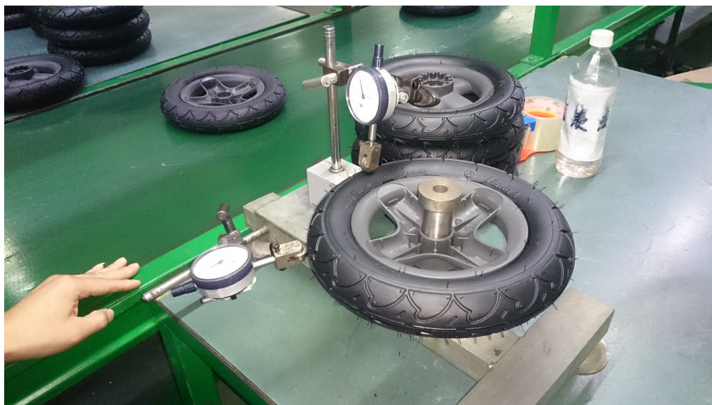
Figur 3.29: Manuell kontroll av rundhet
