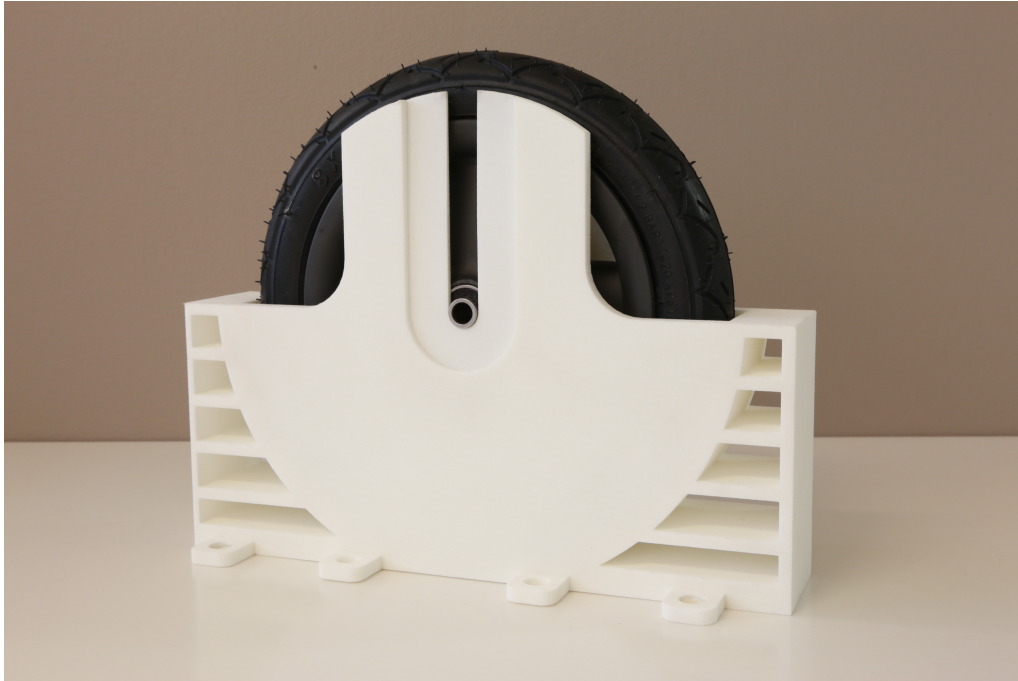
Figur 4.7: Fikstur for montering av gaffel til hjul
