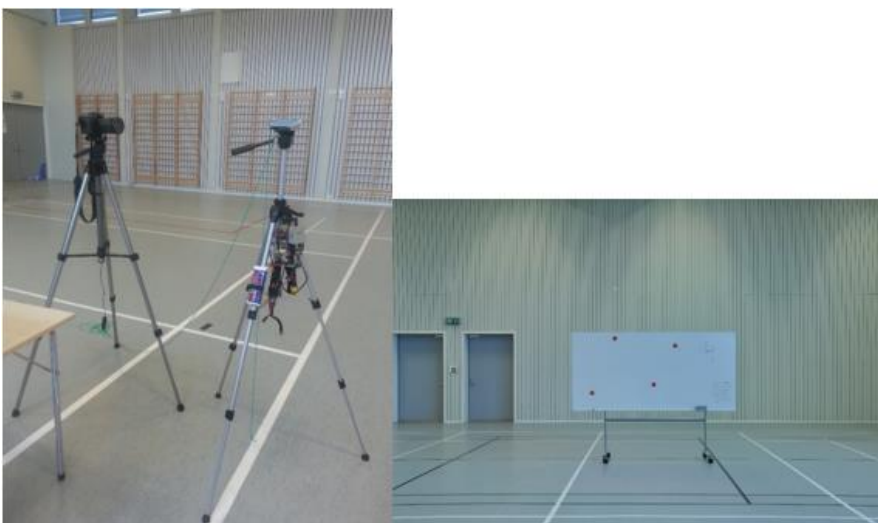
Figur 5-14 Oppsett for lab gymsal. Bildet viser oppsettet av kameraet og lasermåleren (til venstre), og et eksempel bilde av tavlen (til høyre).
