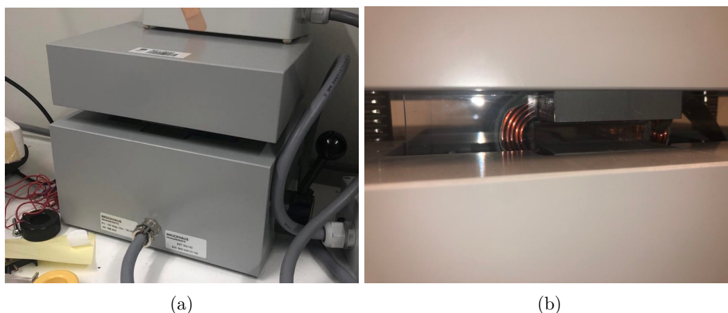
Figur 13: Måleboksen (a) og spolen (b) for spolesystemet SST50x150.
