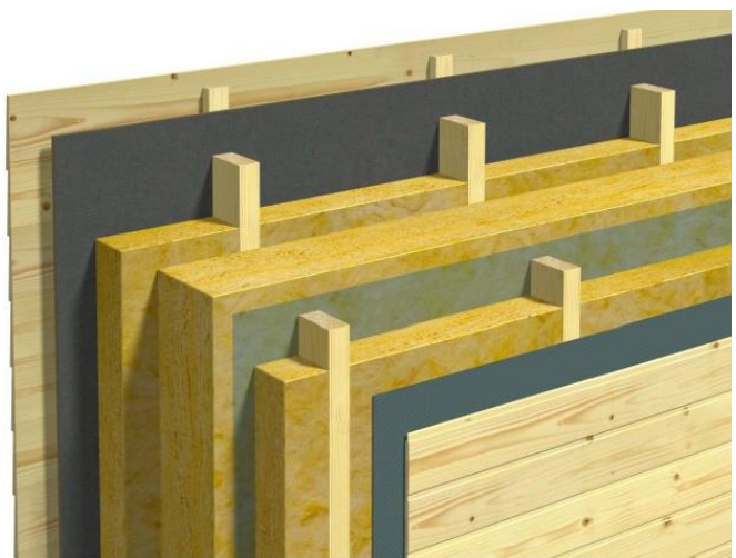
Figur 14 Prinsipiell oppbygging av todelte vegg med stender i heltre. Kilde: ENTRÈ – energieffektive trekonstruksjoner. Delrapport 2
