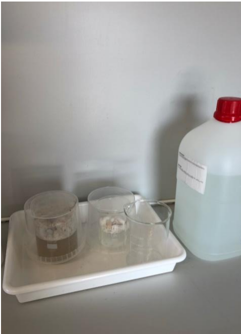
Bilde 16: Mageinnhold fra mink overført til et begerglass og tilsatt hydrogenperoksid.
