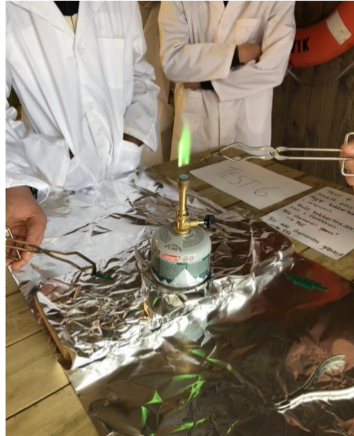
Bilde 10: Identifisering av plast via test 6. Grønn flammefarge indikerer polyvinylklorid (PVC).
