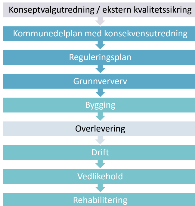
Figur 2 – Overordnet skjematisk fremstilling av planprosessen (Statens Vegvesen, u.d.)
